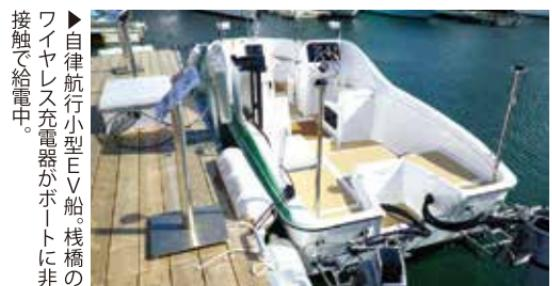
▶自律航行小型EV船。桟橋のワイヤレス充電器がボートに非接触で給電中。
